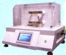
MB401B静电衰减性测试仪
