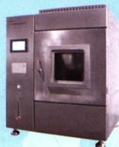
NW266口罩阻燃性能测试仪
