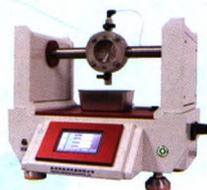
YG812F防护服耐压合成血穿透测试仪
