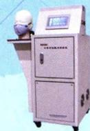
NW260口罩呼吸阻力测试仪
