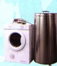
YG403织物摩擦带点测试仪
