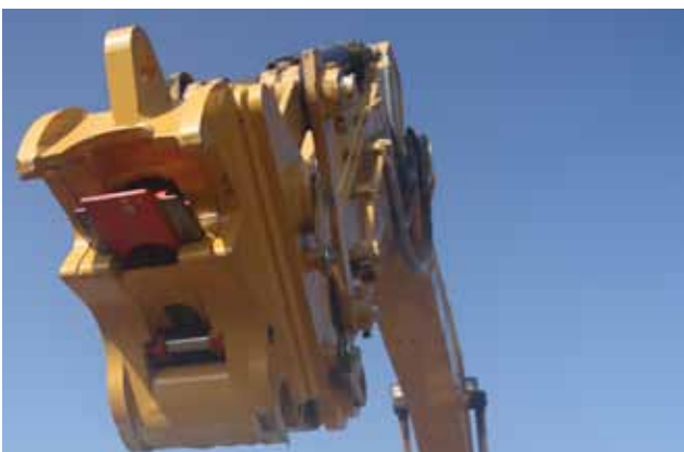
19 卡特彼勒推出最新一代抓销式快速连接器
