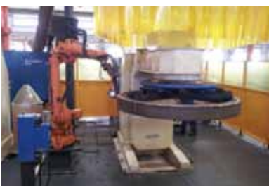
焊接机器人在平地机 回转圈焊接中的应用
