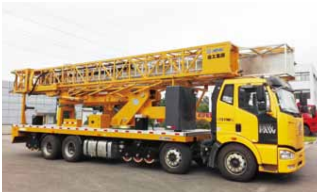
国内最大参数桁架式 桥梁检测车在徐工下线
