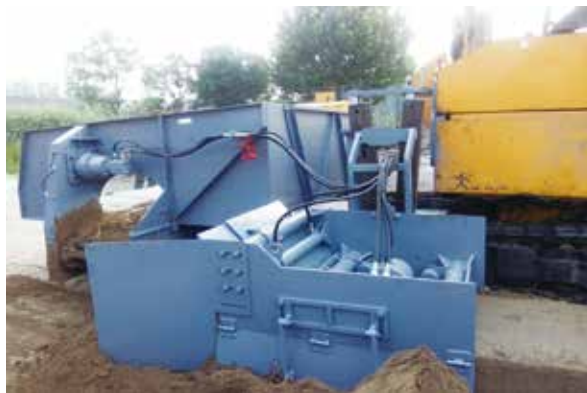
101 路肩摊铺新利器 天顺长城RSP800型履带式路肩土摊铺机牛刀小试
