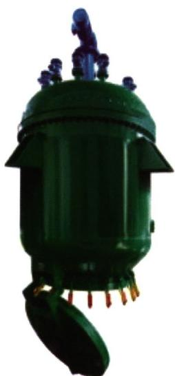
树脂交换效果好，避免了常规离子交换柱的短路、沟流和树脂破碎后液体流动阻力大等弊端；
