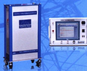
干式空心电抗器匝间绝缘缺陷检测系统
