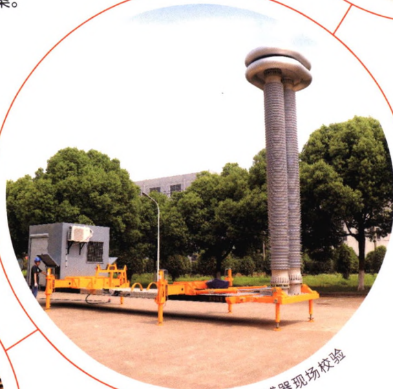
大容量电缆交流耐压试验
