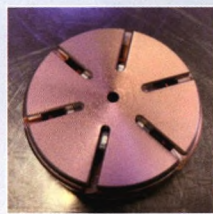
槽口尖角未倒角的触头老练试验前后
