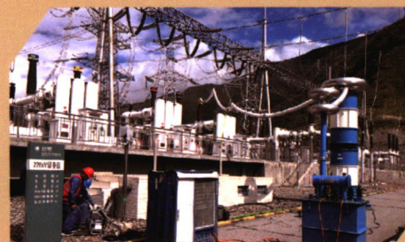
GIS 同频同相交流耐压试验
