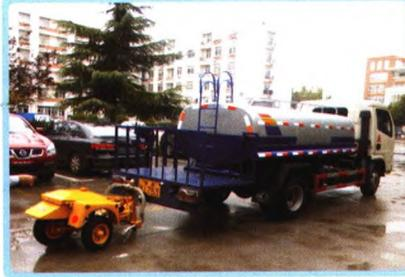
(英国) MUMETER Mk6 DOUGLAS SPD 路面摩擦系数测定仪
