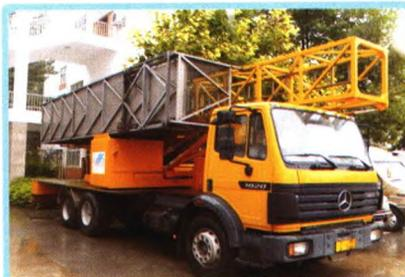
(德国奔驰) 桁架式桥梁检测车
