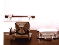
通讯管道摩擦系数测定系统
