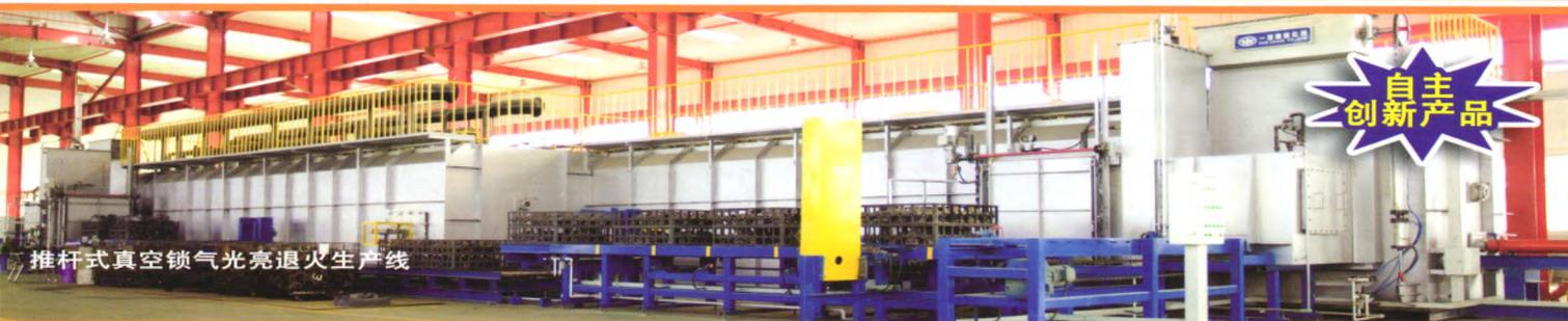
推杆式真空锁气光亮退火生产线
