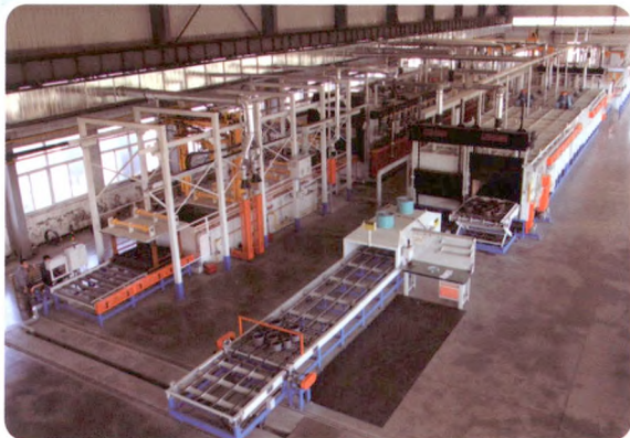
节能型辊棒炉盐浴淬火生产线
