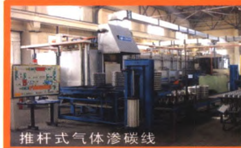
推杆式气体渗碳线
