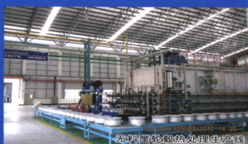
连续式高架无料筐 轮毂热处理生产线
