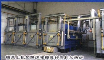
模具上机加热炉和模具补涂料加热炉
