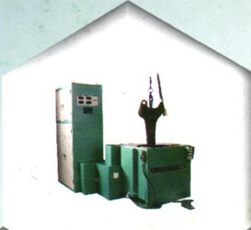
XGT-A型旋转磁场车钩零件探伤机
