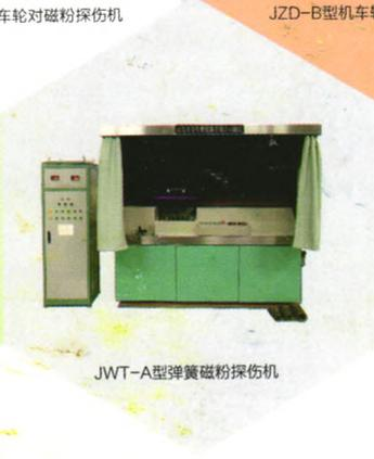
JWT-A型弹簧磁粉探伤机
