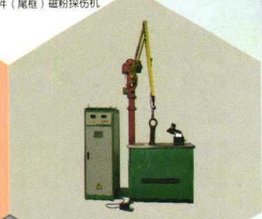
XJD-B型旋转磁场井式连杆探伤机
