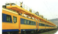
JJC型接触网检修作业车(作业部分)
