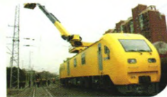
DAS7型接触网检修作业车
