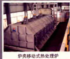
炉壳移动式热处理炉
