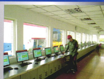
热处理炉群监控系统
