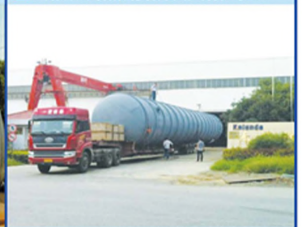
▲ 为扬子石化制作的初馏塔 材质: Q345R+S32168
