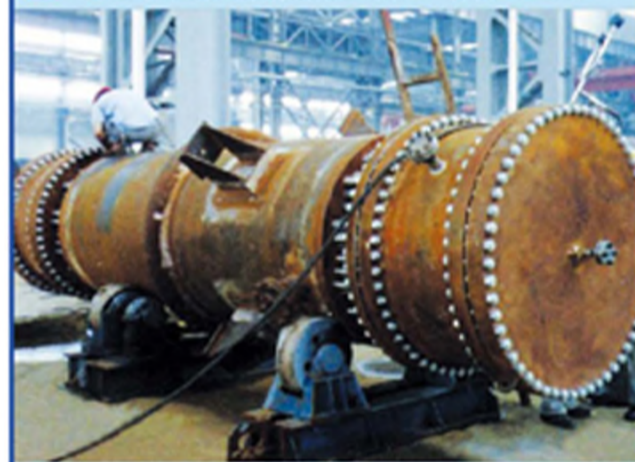
▲ 为上海石化制作的双管板换热器 材质: Q345R+10#
