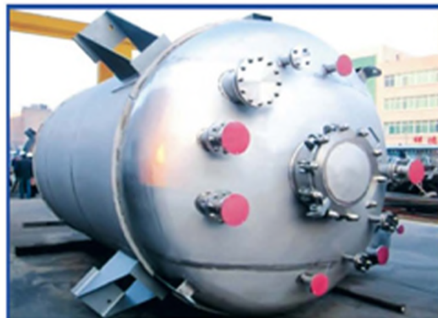
▲ 为上海金山石化制作的减压解聚釜 材质: S22053
