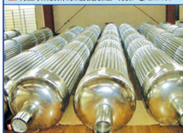
▲ 出口伊朗的80立方米换热器 材质: TA2
