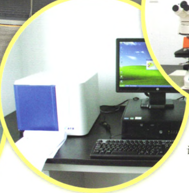
法国梅里埃ATB微生物鉴定仪：微生物理化鉴定及药敏试验
