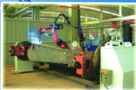
头尾式 1 轴变位机 +7 轴机器人工作站
