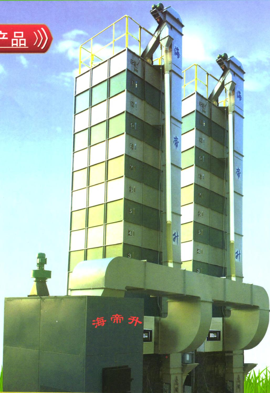
热风炉可燃稻壳、秸秆、木屑、葵皮、煤炭、谷糠等生物质再生能源，多种小颗粒状或粉状燃料在半浮动状态下得到较完全的燃烧，热风效率可达70%以上，并可实现自动化生产作业，既环保又节约成本，且操作简单，效果优良。
