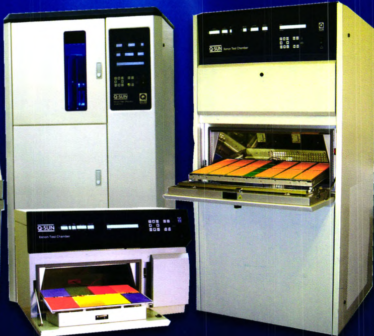
Q-SUN Xe-1, Xe-2, Xe-3氙灯试验箱
