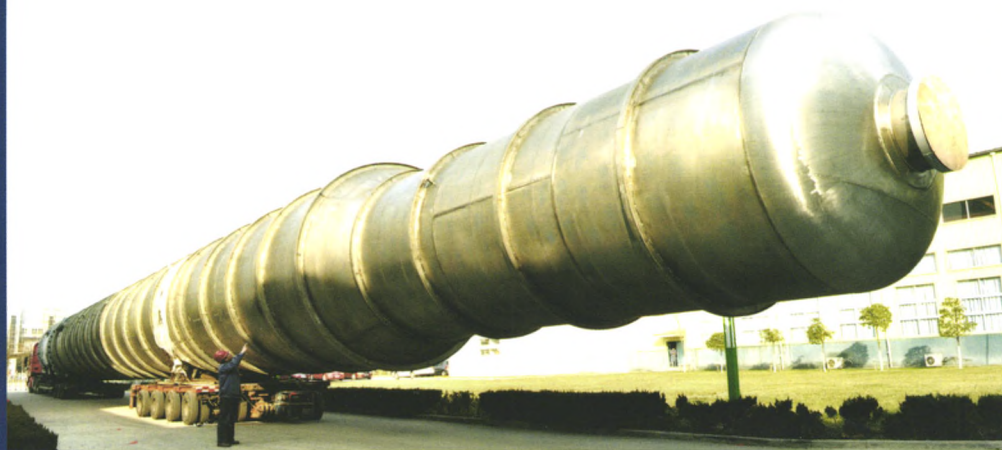
醋酸装置锆脱水塔 Zr702 (φ3.6×51m)
