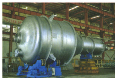
醋酸装置闪蒸罐 HB-3 (φ4.0m)
