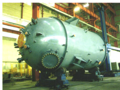
醋酐装置碳化反应器 Zr/Ti/CS (45m 3 )
