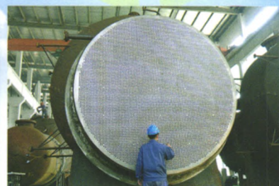
PTA装置 钛材氧化反应冷凝器 (换热面积5850m 2 )
