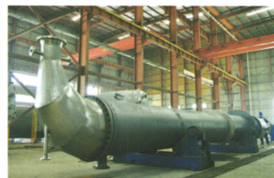
丁辛醇装置 高低压降膜蒸发器 316L
