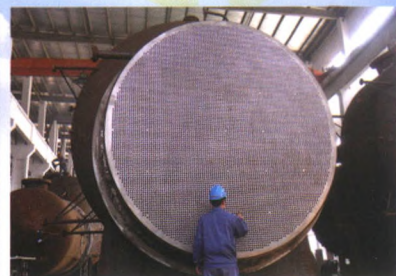
PTA装置 钛材氧化反应冷凝器 (换热面积5850m 2 )
