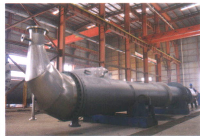
丁辛醇装置 高低压降膜蒸发器 316L
