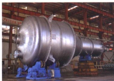
醋酸装置闪蒸罐 HB-3 (φ4.0m)
