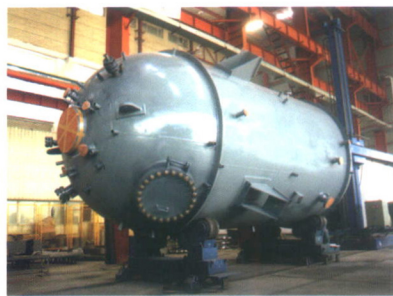
醋酐装置碳化反应器 Zr/Ti/CS (45m 3 )
