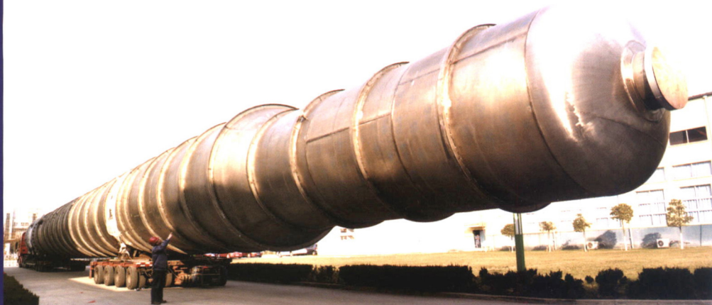
醋酸装置锆脱水塔 Zr702 (φ3.6×51m)
