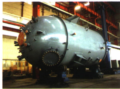
醋酐装置碳化反应器 Zr/Ti/CS (45m 3 )
