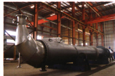
丁辛醇装置 高低压降膜蒸发器 316L
