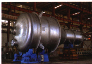
醋酸装置闪蒸罐 HB-3 (φ4.0m)
