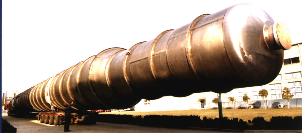
醋酸装置锆脱水塔 Zr702 (φ3.6×51m)
