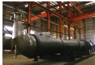
丁辛醇装置 高低压降膜蒸发器 316L
