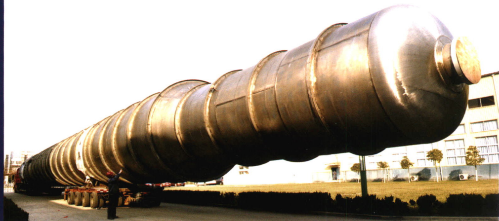
醋酸装置锆脱水塔 Zr702 (φ3.6×51m)
