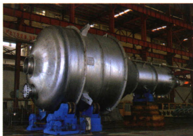
醋酸装置闪蒸罐 HB-3 (φ4.0m)
