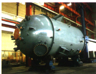
醋酐装置碳化反应器 Zr/Ti/CS (45m 3 )
