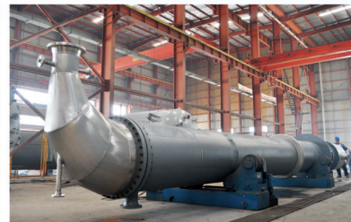
丁辛醇装置 高低压降膜蒸发器 316L
