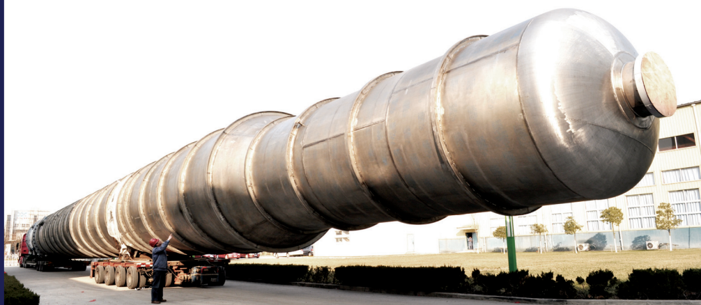
醋酸装置锆脱水塔 Zr702 (φ3.6×51m)
