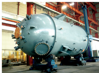
醋酐装置羰化反应器 Zr/Ti/CS (45m 3 )
