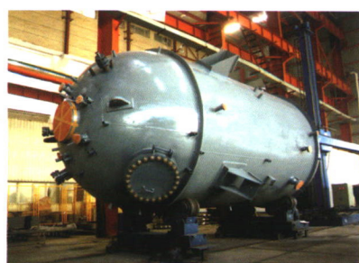
醋酐装置碳化反应器 Zr/Ti/CS (45m 3 )
