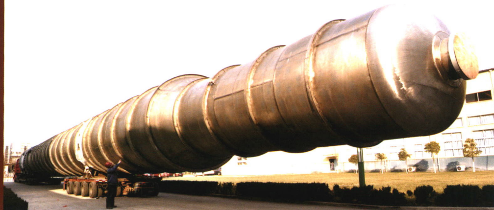
醋酸装置锆脱水塔 Zr702 (φ3.6×51m)
