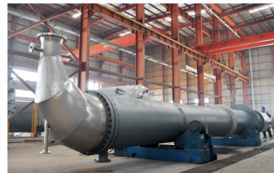
丁辛醇装置 高低压降膜蒸发器 316L
