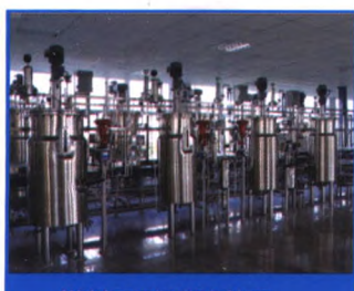
燃料乙醇试验装置
