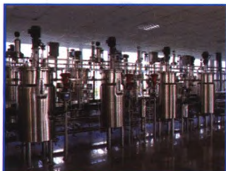
燃料乙醇试验装置
