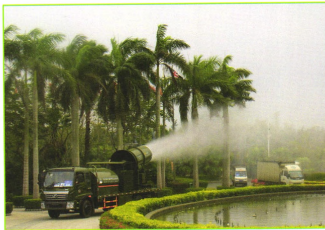
一种控制PM 2.5 空气质量超标的移动式水雾降尘机车 （专利号：201220226287.6）
