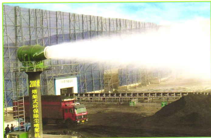
控制PM 2.5 空气质量超标的塔架式水雾降尘装置 （专利号：201220207087.6）
