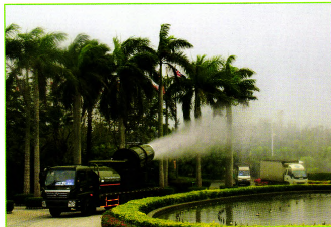
一种控制PM 2.5 空气质量超标的移动式水雾降尘机车 （专利号：201220226287.6）
