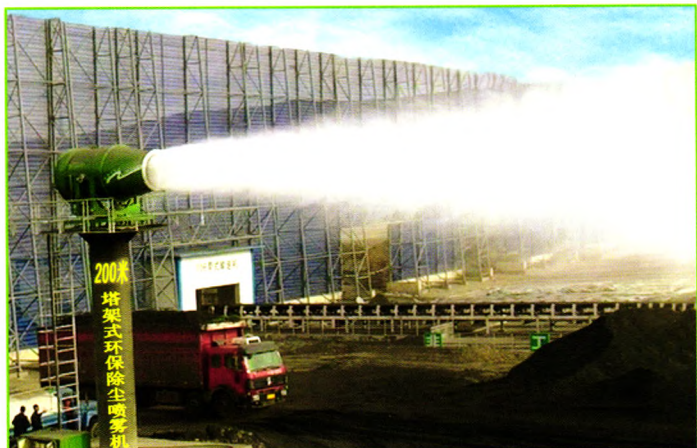
控制PM 2.5 空气质量超标的塔架式水雾降尘装置 （专利号：201220207087.6）
