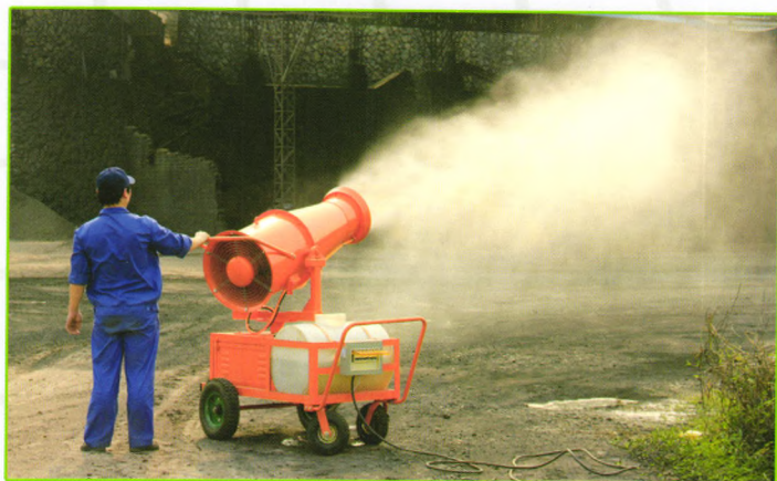
手推式环保降尘喷雾装置（小范围的喷雾降尘）
