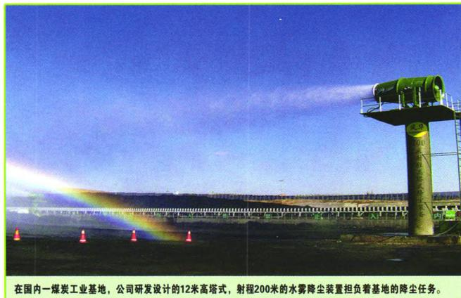
在国内一煤炭工业基地, 公司研发设计的12米高塔式, 射程200米的水雾降尘装置担负着基地的降尘任务。
