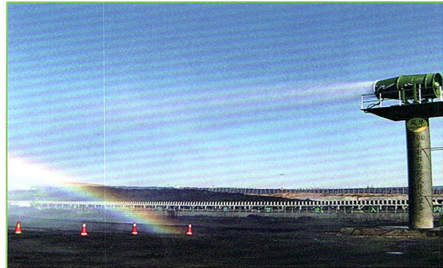
在国内一煤炭工业基地，公司研发设计的12米高塔式，射程200米的水雾降尘装置担负着基地的降尘任务。
