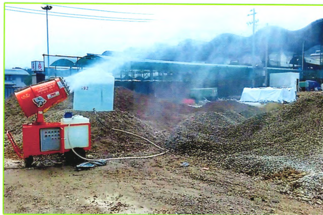
手推式环保降尘喷雾装置（小范围的喷雾降尘）
