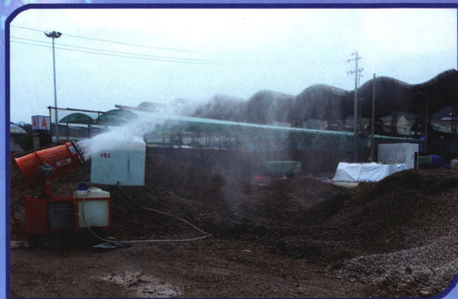
手推式环保降尘喷雾装置 (小范围降尘)
