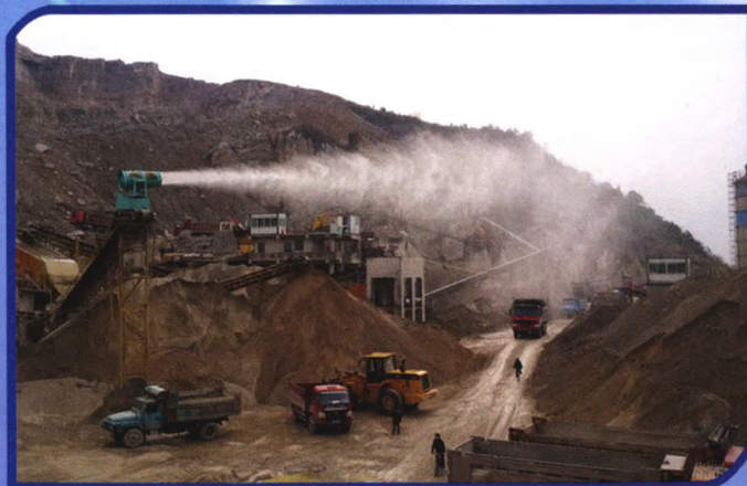
控制扬尘超标的塔架式水雾降尘装置 (专利号：201220207087.6)
