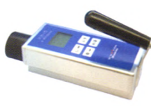
\chi 、 \gamma 吸收剂量率仪
