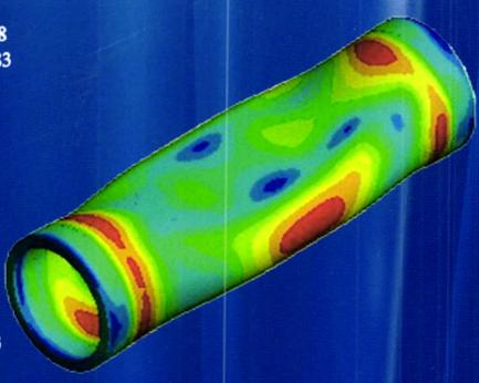
冷冻阀在不同加热功率密度下的应力分布 (P. 020301)
