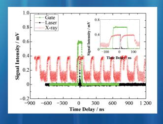
4G示波器采集的快速光电二极管探测到的激光(底层窄单脉冲)和X射线脉冲(多脉冲波), 以及提取单束团X射线脉冲的门控信号(单脉冲波)(P.100101)
