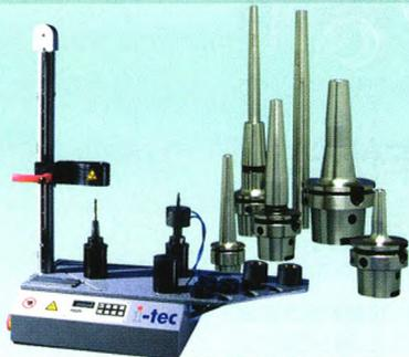
热套夹头及热套装置
