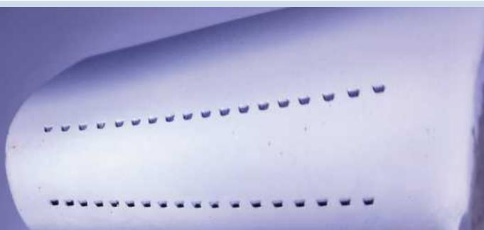
超快激光加工涡轮叶片气膜冷却孔技术研究
