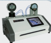
SPMK2000T 微差压自动检定系统
