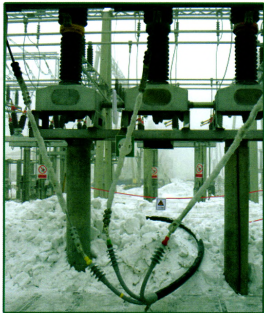
实验开始前试验用覆冰导线状况
