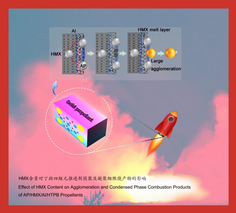
HMX含量对丁羟四组元推进剂团聚及凝聚相 燃烧产物的影响
